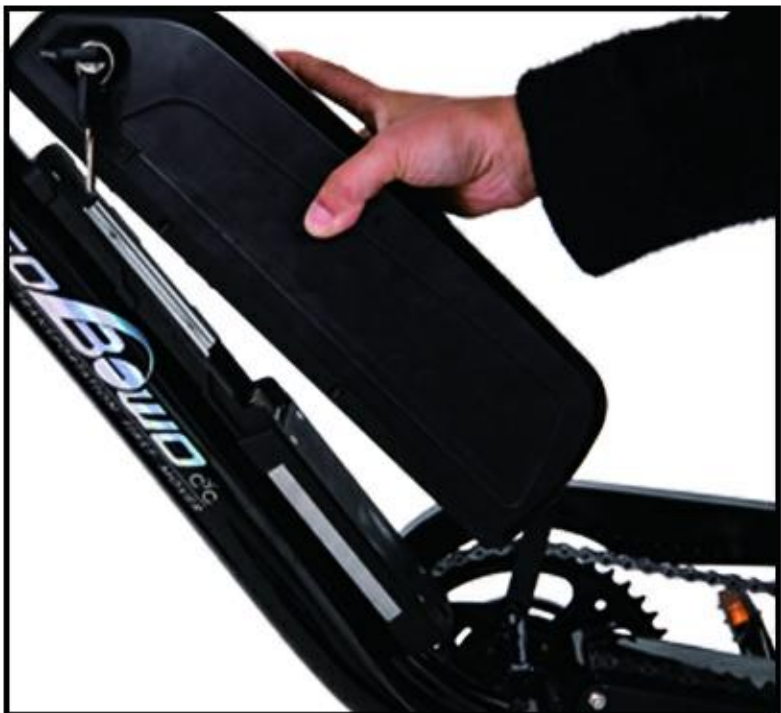
第二步：将电池沿卡 槽卡入电池底座。
