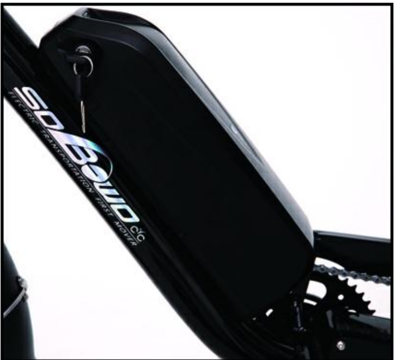
第三步：将电池推进 卡槽，安装到位。
