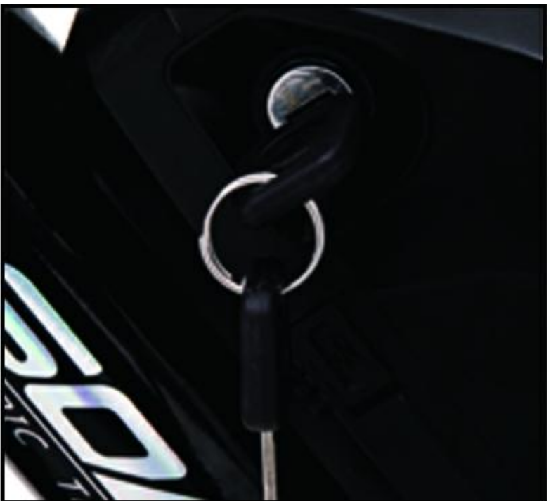
第四步:将钥匙往 LOCK方向旋转， 锁上电池。
